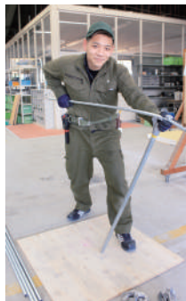
金属管曲げ作業
